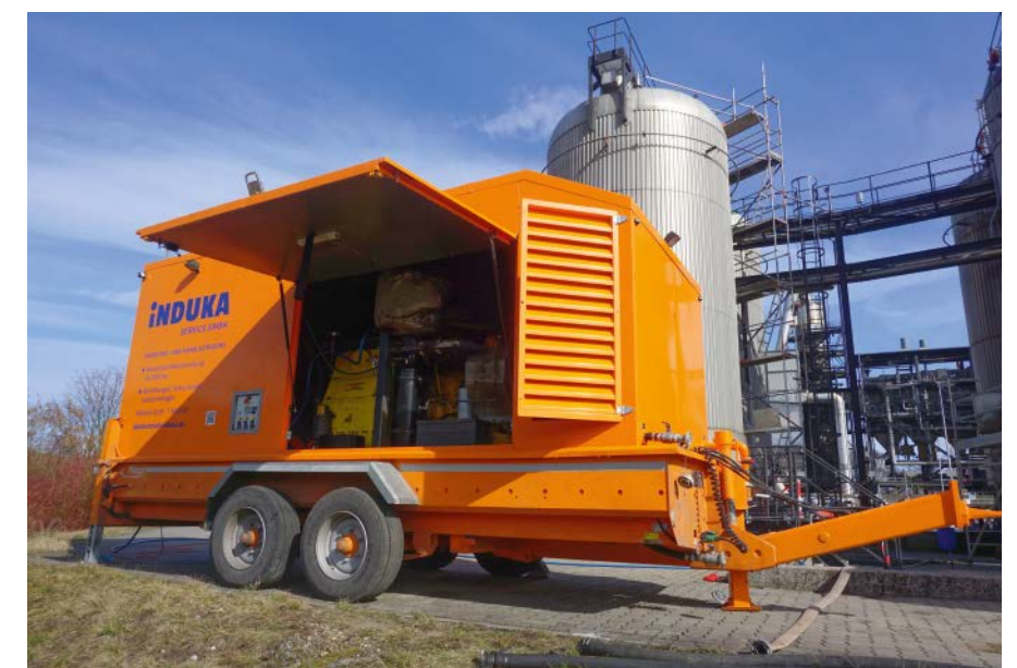
Moderne Technik: Hochdruck-Aggregat mit 3000 bar für die schwierigsten Fälle der Industriereinigung
